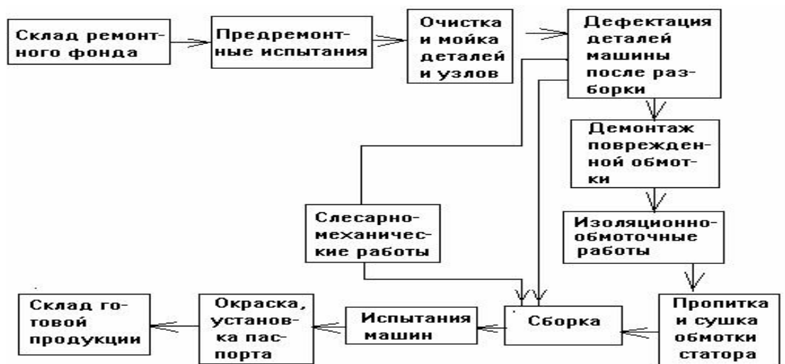
Рисунок 2.1 - Схема ремонта электрических машин
